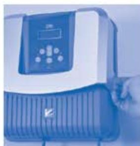
6. Odstraňte prázdný původní modul a nahraďte jej novým modulem TRi pH. Připojte plochý kabel modulu TRi pH (plochý kabel s černým zástrčkovým konektorem) do odpovídajícího černého zásuvkového konektoru síťového zdroje TRi.
