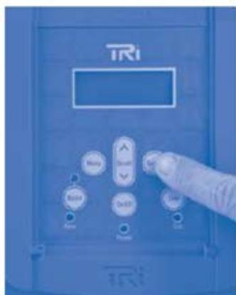
5. Pomocí tlačítek zobrazte 'PH SETUP', potom stiskněte tlačítko .
