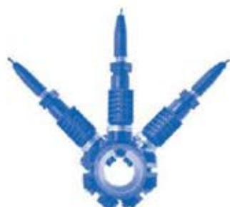
2. Svorka musí být namontovaná vodorovně, se závitovým otvorem nahoru. pH tester musí být v kolmo (tolerance 45° vzhledem ke kolmici).
