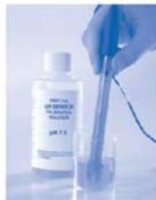
3. Ponechejte pH tester ponořený do tlumícího roztoku přibližně na 5 minut, aby bylo zajištěno spolehlivé měření.
