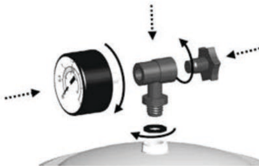
MONTÁŽ TLAKOMERU (S VENTILOM)
